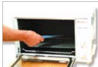
Bauteil 4 - 6 min bei ca. 140° C im Ofen erwärmen.
